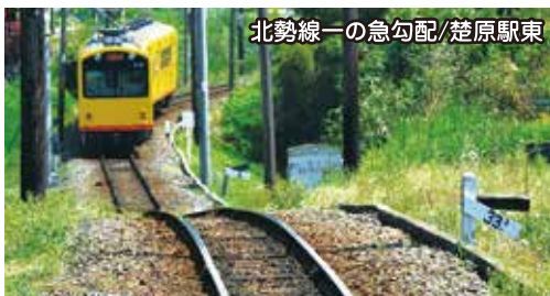
八幡神社付近は、線路の 曲線半径が北勢線最小です。
