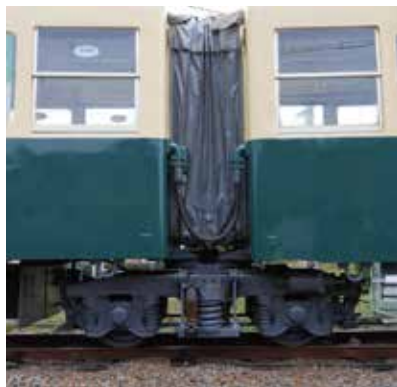
車両と車両を台車で連結する200系の連接台車
